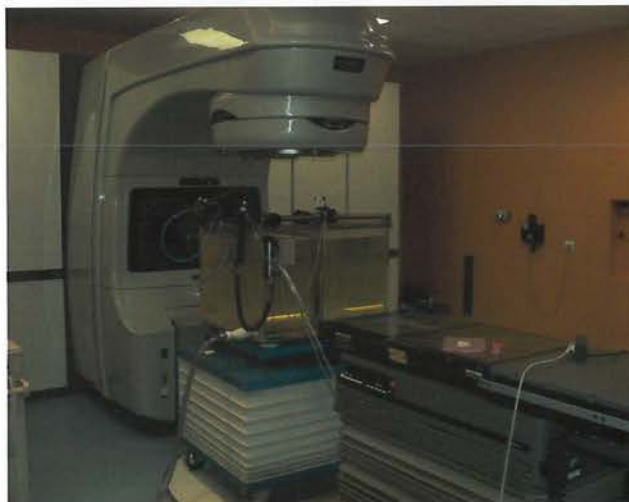
Ryc. 4. Wodny, automatyczny fantom pomiarowy umieszczony jest w obszarze wiązki promieniowania. Pozwala on na pomiar zmiany dawki w funkcji głębokości (w osi wiązki) oraz w odległości od osi wiązki
