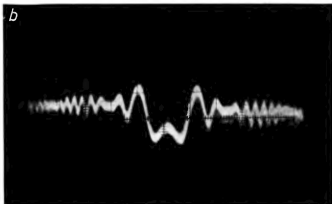
Rys. 5. Dyfrakcja na pionowym cienkim pręcie: a) widok z ekranu monitora TV, b) rozkład natężeń obserwowany na ekranie oscyloskopu
